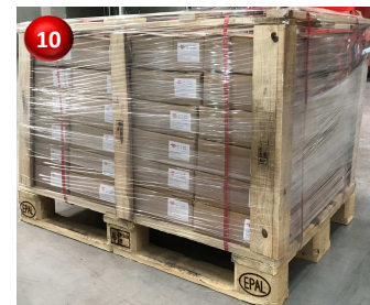
Schritt 10: Prüfen der Palettenfüsse. Die müssen frei sein.
