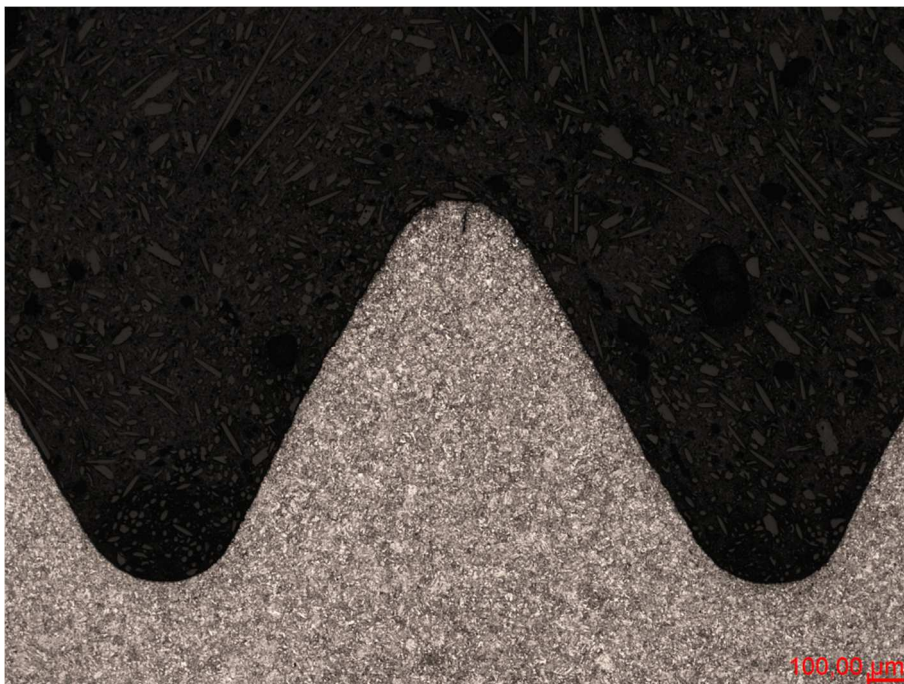
Abbildung 2: Randbereich, am Gewinde, Muster 4, Längsschliff, geätzt mit 3% HNO 3 , Zeiss Axio Imager/50x
